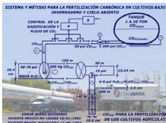
Figura 11. Sistema industrial para la captura de \text{CO}_{2(\text{gas})} , licuado y almacenamiento y la tecnología agrícola para la aplicación de \text{eCO}_{2(\text{gas})} en cultivos agrícolas que cuentan con riego presurizado.
